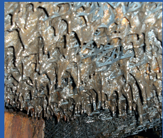
Filter vor der Behandlung mit Huwa-San
